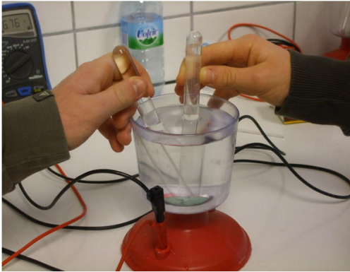
وثيقة 3 - نواتج التحليل الكهربائي للماء
